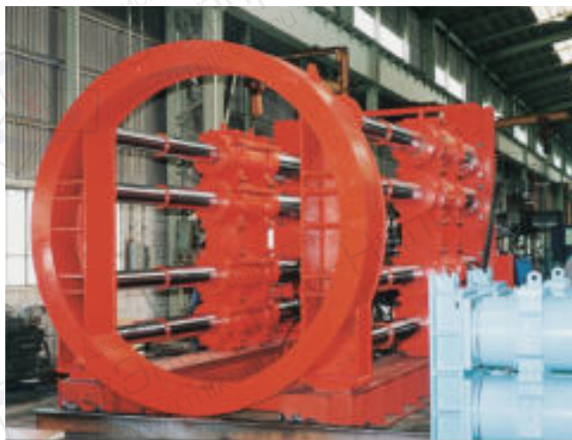
2000кН, 8 цилиндров, ход штока 3000мм
