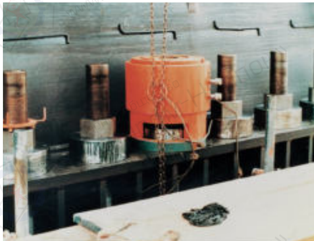
Гидравлический натяжитель болтов 5000 кН
