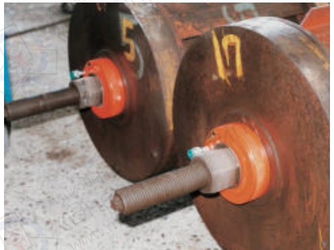
Гидравлический домкрат 1000кН, ход штока 350мм
